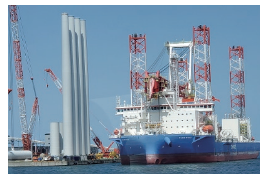
風力発電施設は専用の船で高さ約90mの支柱に長さ約80mの羽が3体取り付けられます。
